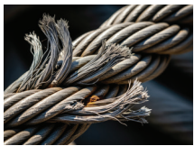
Frayed ramp door cables
